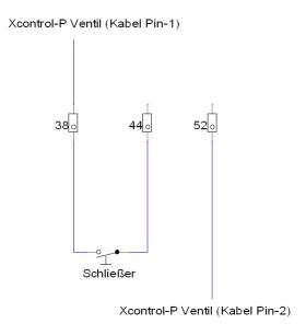
Das Anschlusskabel des Xcontrol-P muss dazu in das Xcontrol-E geführt werden. Pin 1 des Kabels ist im Xcontrol-E auf Reihenklemme X1:38 (oben) aufzulegen. Pin 2 des Anschlusskabels ist auf Reihenklemme X1:52 (unten) aufzulegen. Die Schaltung des Ventils erfolgt dann dadurch, dass ein Schalter (Schließer) zwischen Reihenklemme X1:44 (unten) und X1:38 (unten) eingebunden wird.
