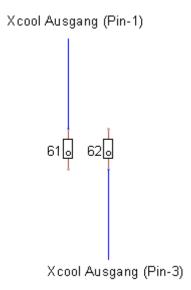
Ausgang Pin 1 des Xcool ist auf Reihenklemme X1:61 (oben) und Ausgang Pin 3 auf Reihenklemme X1:62 (unten) aufzulegen. Dazu ist die Brücke zwischen X1:61 und X1:62 zu entfernen.
