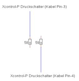
Pin 3 des Xcontrol-P Anschlusskabels ist auf Reihenklemme X1:58 (oben) und Pin 4 auf Reihenklemme X1:59 (unten) aufzulegen. Dazu ist die Brücke zwischen X1:58 und X1:59 zu entfernen.
