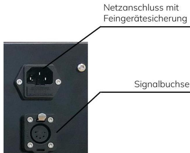
Das Kaltgerätekabel ist in den Netzanschluss zu stecken und auf einen festen Sitz zu prüfen. Die Gerätefeinsicherung ist bei der Auslieferung bereits eingebaut.
