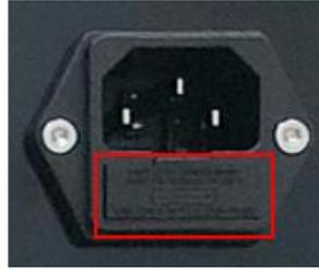
Die alte Sicherung ist zu entfernen und gegen eine neue zu tauschen. Anschließend muss das Sicherungsfach wieder eingelegt werden, bis es einrastet. Das Xcool ist wieder betriebsbereit.
